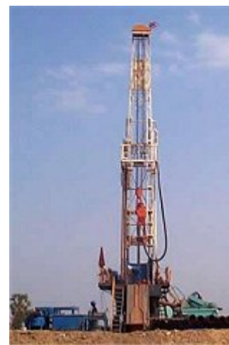
Εικόνα 14: Γεώτρηση για εξόρυξη αλατιού με διάλυση στην Ταϊλάνδη.:
